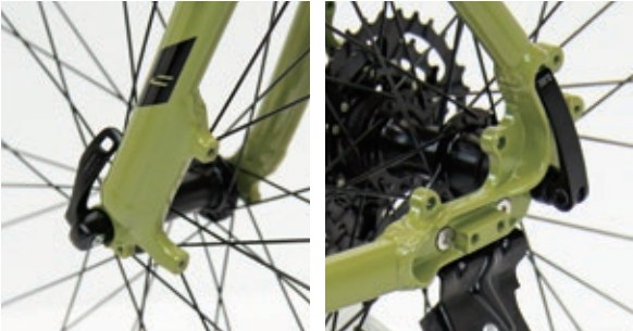
フロントフォークにディスクブレーキ台座、フレーム リアエンドにフエンダーアダボ & キャリアアダボ、ディスクブレーキ台座付
